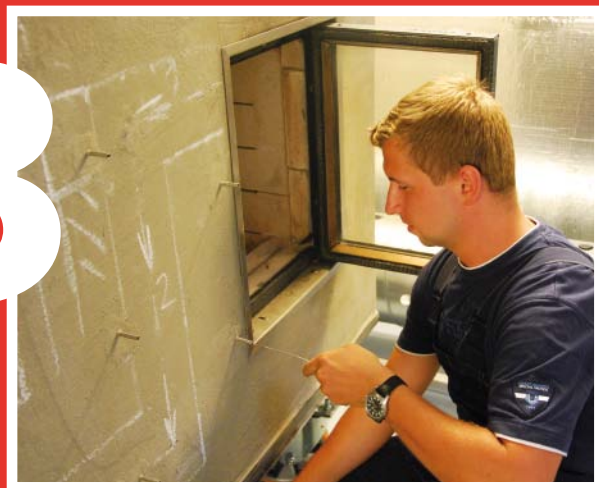
Montáž čidel pro snímání tlaků a teplot.
