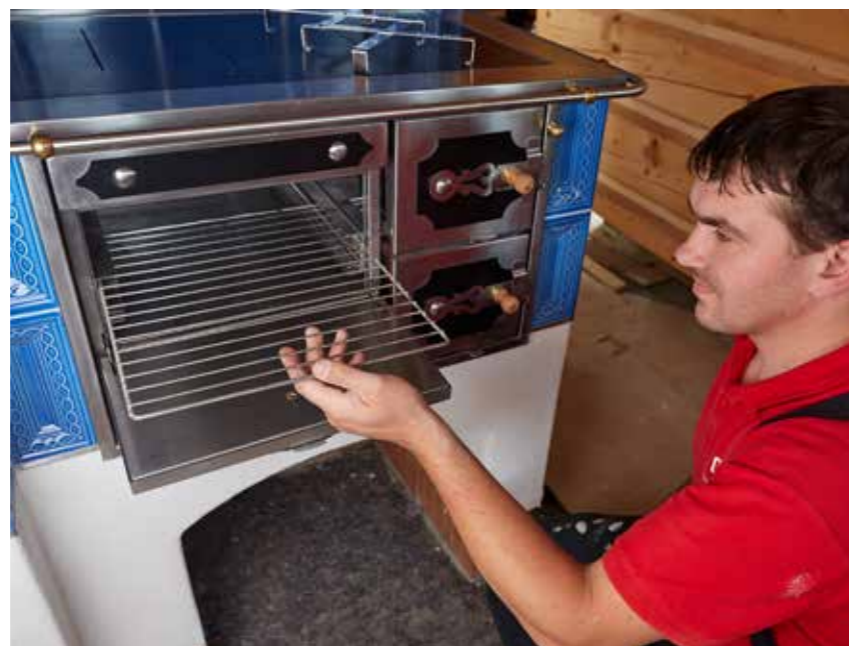
Při pečení v troubě mohou Osvaldovi používat stejné rošty a pekáče, jako v té klasické. Narozdíl od horkovzdušné trouby, která měří teplotu, je však třeba se s touto nejdříve sžít a několika prvními pokusy zjistit, jak dosáhnout požadované teploty i bez elektronických ukazatelů.
