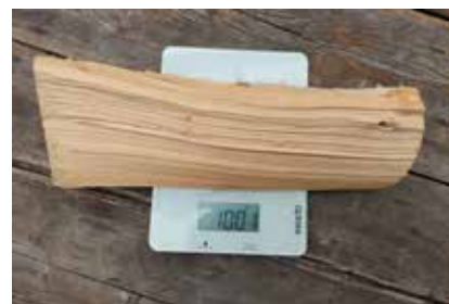
Štípané smrkové polínko o hmotnosti 1001 g a energetické vlhkosti 15 %.
